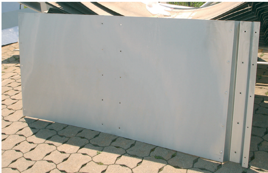
Gereinigtes Blech mit einwandfreier Oberfläche - sie waren also "doch zu retten".
